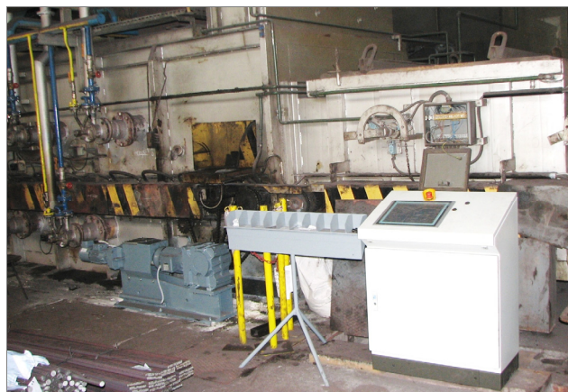
Predkomora in žarilna komora s pogonskim sklopom PS2
