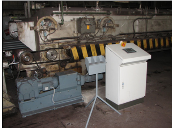
Novi pogonski sklop PS4, za delovni in hitri pogon
